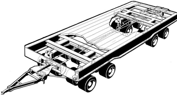
Die ESR-Transportsysteme Anhänger werden in einer Vielzahl von Ausführungen gebaut, je nach Nutzlast, Lenkung, Anzahl der Achsen, Bereifung, Ladefläche, Bremsen und Beleuchtung.
